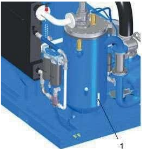
Рис. 36: Проверка уровня компрессорного масла через смотровое стекло
