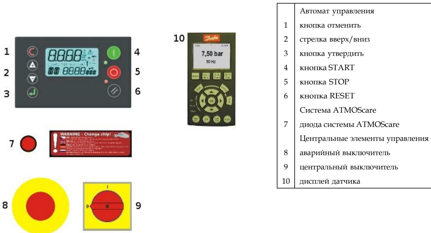
Все функции компрессора управляемы контроллером находящимся на переднем панели. Кнопками стрелок (вверх и вниз) можно переключать указанные данные на дисплее (температура, рабочие часы и под.). Кнопка RESET служит к аннулировании тревожных входов (если тревога не находится в постоянной активности) и к возвращении на исходный экран.
