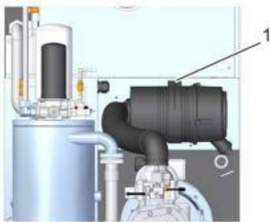
Рис. 37. Расположение воздушного фильтра
